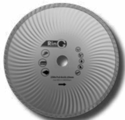
**ПРИМЕНЕНИЕ:** универсальный диск для разных бетонов, тротуарной плитки, облицовочного кирпича, черепицы. Применяется на ручных УШМ для сухой и влажной резки.
